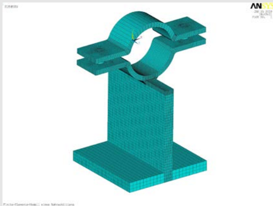
Bild 1: Finite-Element-Modell eines Rohrslittens
